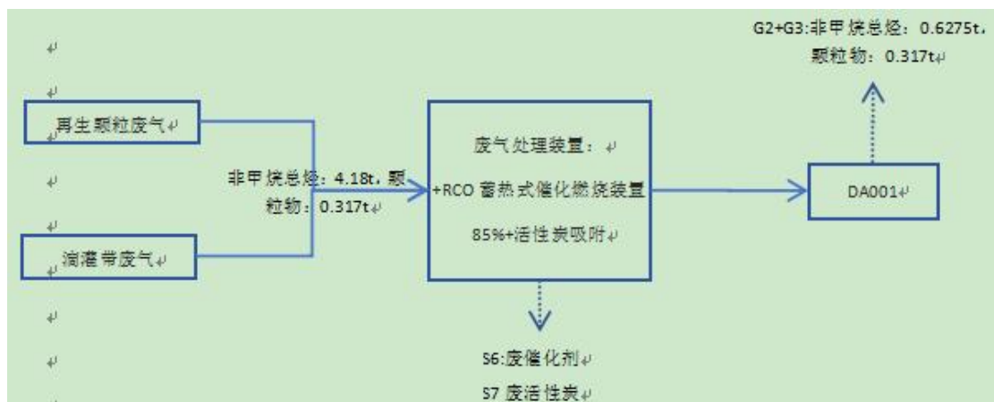
图 3.6-2 有组织废气产生及处理工艺及产污节点图 (单位: t/a)
